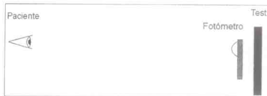
Fig. 5. Posición del fotómetro para la medida de la iluminancia.
