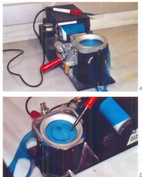
Fig. 5. Maquinaria para la protección. a) Protector del film plástico para la superficie convexa; b) procesos de protección de la superficie convexa del semiacabado.
