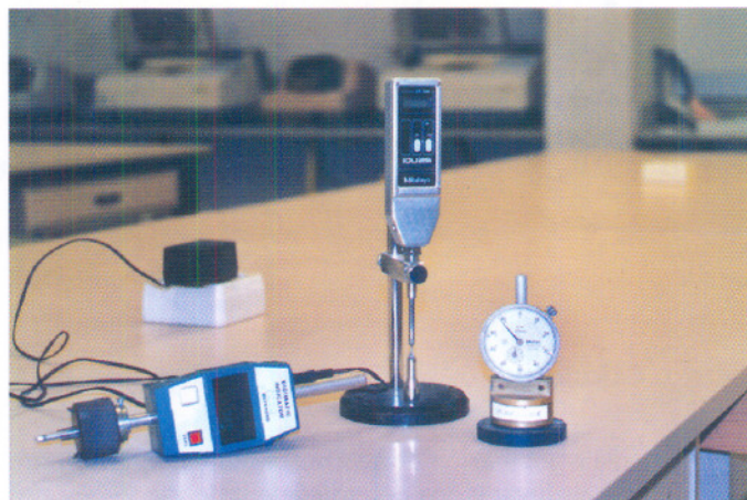
Fig. 2. Herramientas de control: de izquierda a derecha, torímetro, espesímetro y sagímetro.
