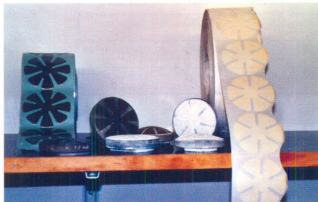
Fig. 9. Afinadora y pulidora. a) Modelos disponibles en la EUOOT; b) felpas autoadhesivas para el afinado (izquierda, aluminizados) y el pulido (derecha, blancos).
