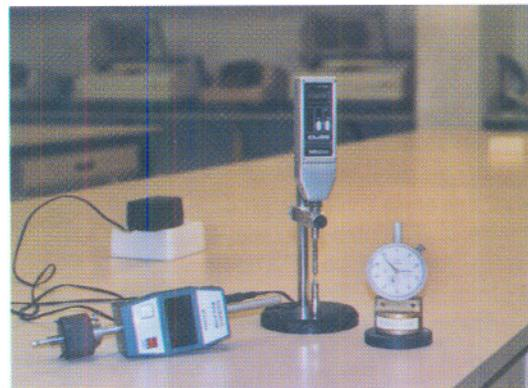
Fig. 1. Instrumentación de control de calidad en el taller: sagímetro (derecha), espesímetro (centro) y torímetro (izquierda sobre la mesa).
