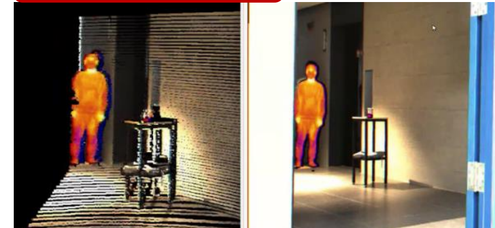
Fig. 8: Fusión en 3D, color y térmica para detección de personas y objetos calientes.
