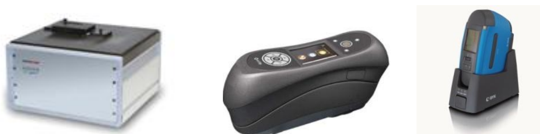
Figura 1: Multi-gonio-espectrofotómetros analizados: Datacolor FX10 (izquierda), con 10 geometrías, X-Rite MA98 (centro), con 19 geometrías, y BYK-mac (derecha), solamente con 6 geometrías.
