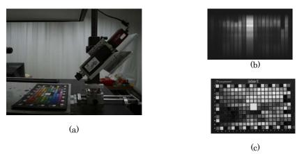
Figura 4. Funcionamiento de un sistema multiespectral: (a) Adquisición de una única línea por parte de la cámara; (b) Escaneado lineal; (c) Obtención de la imagen espectral completa.
