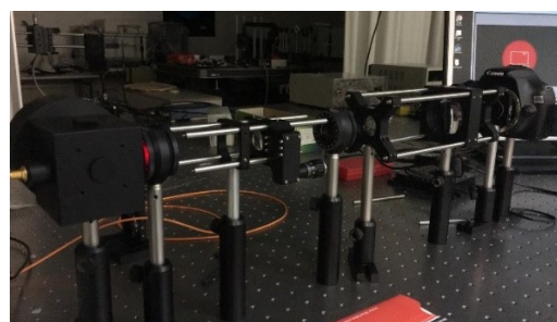
Fig. 1: Esquema de la configuración de calibración (parte superior). La configuración del polarímetro de imagen DoT ya está montada en el banco óptico (parte inferior).
