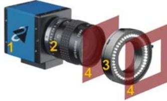
**Figura 1:** Componentes del SMP: 1. cámara, 2. objetivo, 3. anillo LED, 4. polarizadores.
