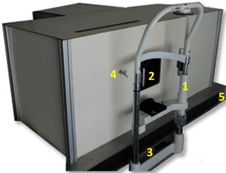
Figura 4-9. Fotografía del aspecto externo del sistema experimental. 1 Mentonera con regulación vertical. 2 Interior del sistema. 3 Regulador horizontal de la mentonera (derecha, izquierda, adelante y atrás). 4 Controlador manual de posición del ocluser. 5 Banco óptico.
