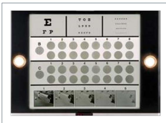
Figura 3-6. Pantalla retroiluminada con dos focos halógenos laterales CSV-1000HGT (Halogen Glare Test) de Vectorvisión™.
