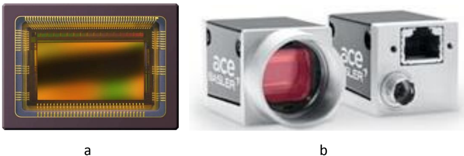
Figura 3-3 (a) Sensor d'imatge CMOSIS CMV2000, (b) Basler aCA2000-50gc
