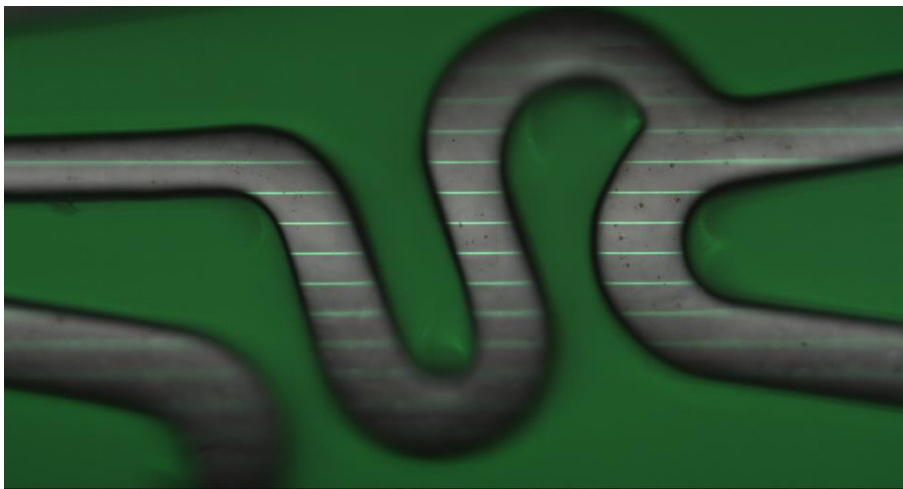
Figura 6-5 Projecció de les ranures horitzontals sobre la mostra. Imatge obtinguda amb un objectiu 20X 0,45NA
