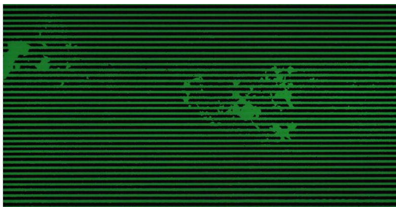
Figura 3-87 Adquisició unrolled de l'espècimen de calibració feta amb un objectiu 5X, on s'observa com s'arrenca la capa d'alumini
