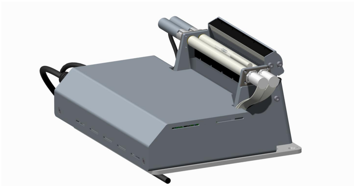
Figura 3-62 Disseny 3D del rotador amb motors i encoders en eix
