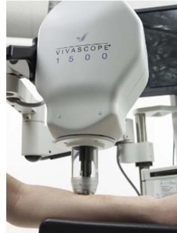
Fig. 6. Izquierda: sistema interferometría láser auto-realimentada. Derecha: sistema de microscopía confocal in vivo.
