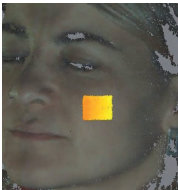
FIGURA 7. Mesures 3D amb textura RGB de color de cara d'una pacient obtinguda amb l'escàner 3D desenvolupat en el CD6. La topografia 3D de la cara es mostra amb una petita subzona rectangular seleccionada a través de l'interfície d'usuari de l'escàner, que permet calcular paràmetres d'interès de la pell com el volum i la rugositat.
