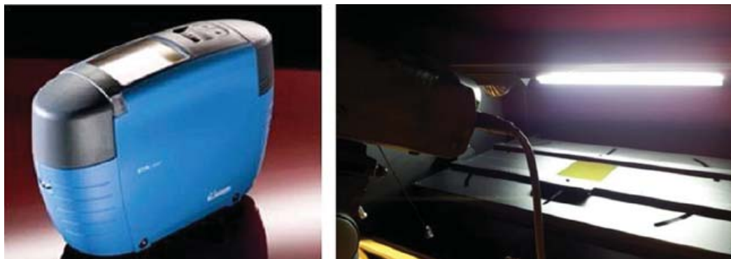
Figura 1. Izquierda: gonio-espectrofotómetro BYK-Mac®; Derecha: Conjunto gonio-espectrofotométrico formado por el tele-espectroradiómetro PR-650® y la cabina de iluminación direccional Byko-spectra effect®.
