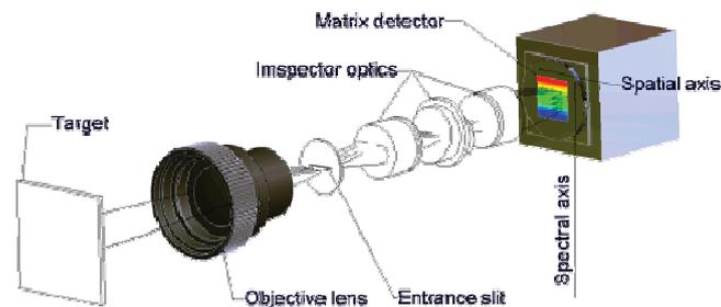
**Figura 1.** Imagen del esquema de un sistema hiperespectral con el objetivo, el espectrógrafo y la cámara CCD matricial.
