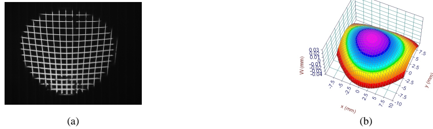
Figura 3: (a) Patrón de líneas correspondiente al frente de onda transmitido por la lente progresiva personalizada. (b) Reconstrucción del frente de onda
