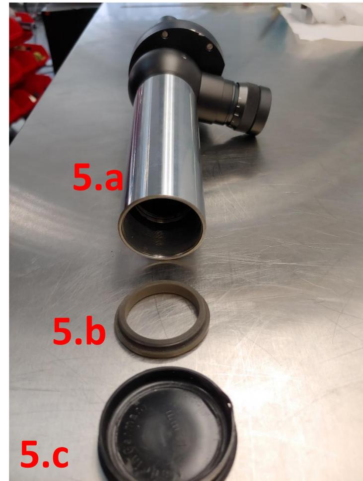
5.a Tubo y ocular del Autocolimador 5
