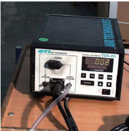
Figura 4. Resultado correcto: no fuga Correct result: filter not leaking Résultat correct: pas de fuit Korrektes Ergebnis: Undicht
